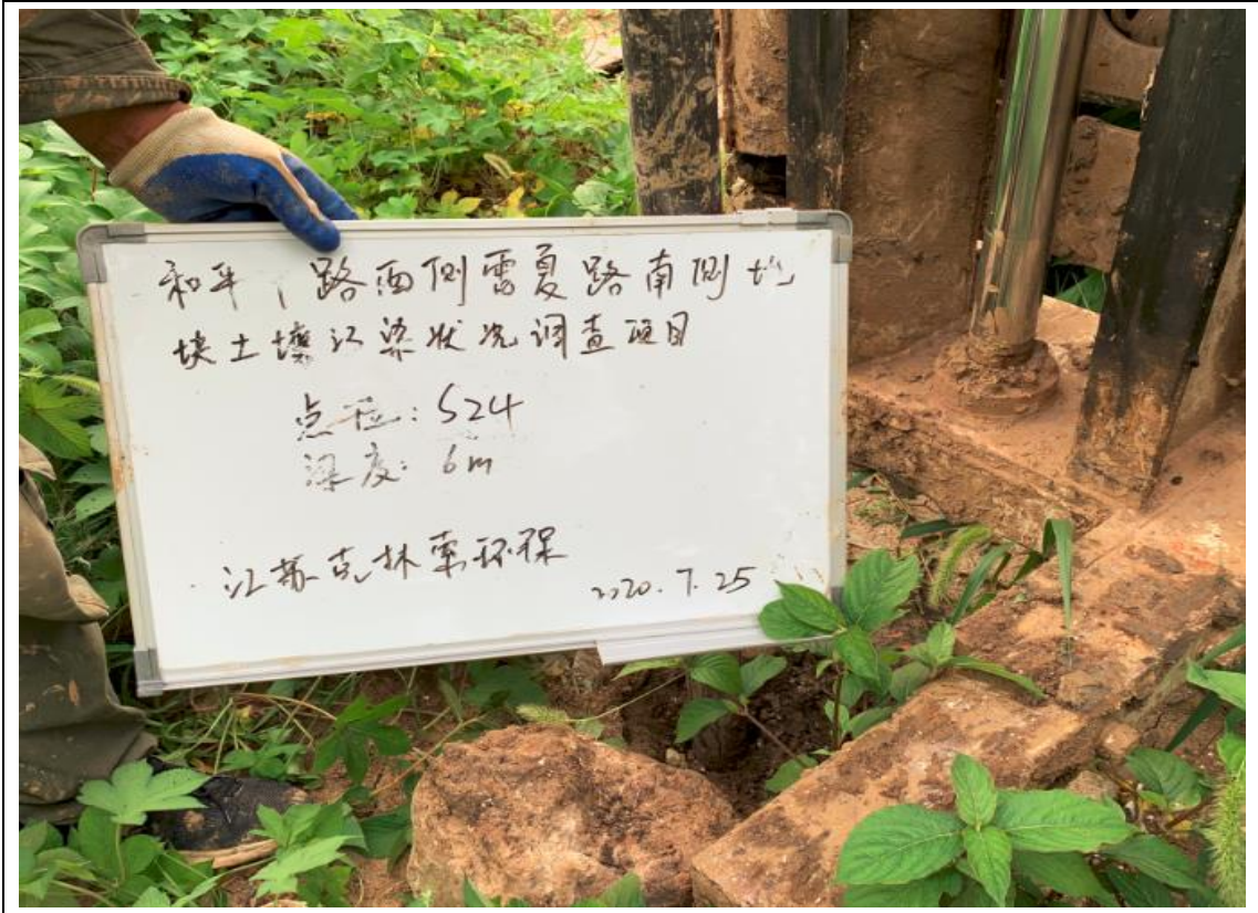
图 6-1 钻井取土采样
