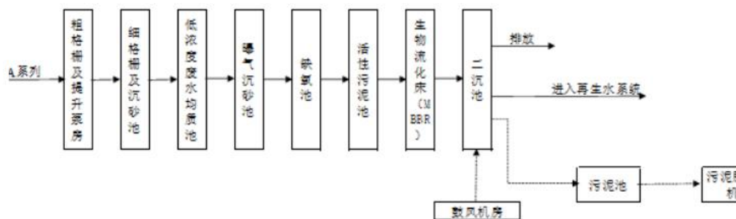
图 4-3 张家港保税区胜科水务有限公司污水处理工艺流程图
