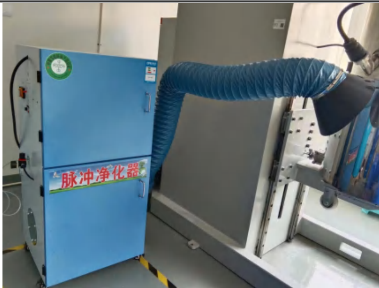
图 3-1 废气处理设备照片
